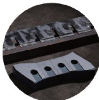
ステンレス材のシム板を取り外すこと無く隙間から差し込むように工夫。作業時間を大幅に削減することでコストダウンを実現しました。
